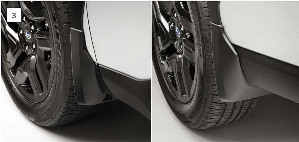
**3** Kit faldillas delanteras y traseras
